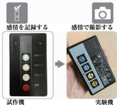
図1. カメラ付きGPSロガーの開発経緯
