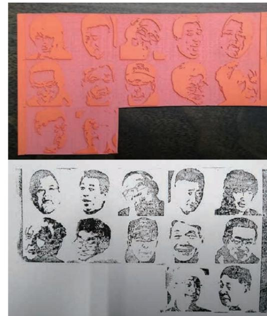
図2. 完成した印面と押印結果
